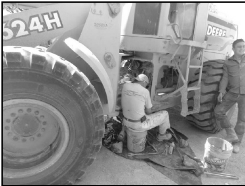
IMAGEN 40. MANTENIMIENTO PREVENTIVO Y CORRECTIVO A LA MAQUINARIA, IMPLEMENTADO MEDIDAS DE PREVENCIÓN PARA DERRAMES DE HIDROCARBUROS
